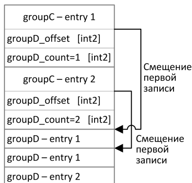
Рисунок 3.2. Схема двухуровневого вложения компонентов
