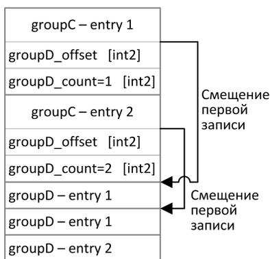
Рисунок 5. Схема двухуровневого вложения компонентов
